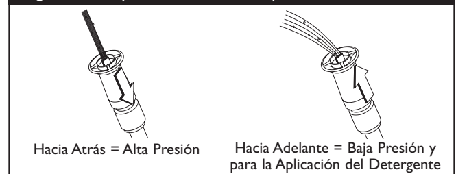
Figura 26 — Ajustar la Presión de Aspersión
